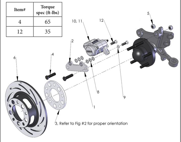
**FIGURE # 3: Spacer Orientation**
